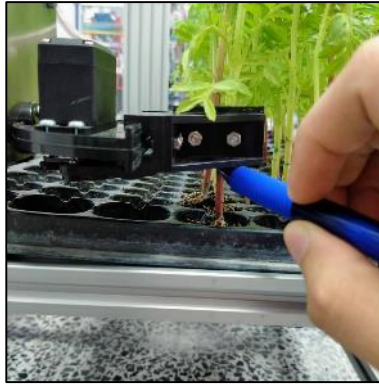
ภาพที่ 16 การขีดตำแหน่งการจับของกริปเปอร์บนต้นกล้าดาวเรือง
