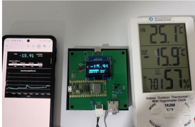
ภาพที่ 6 การเปรียบเทียบค่าอุณหภูมิที่วัดได้ของตู้แช่น้ำยาที่ 1
