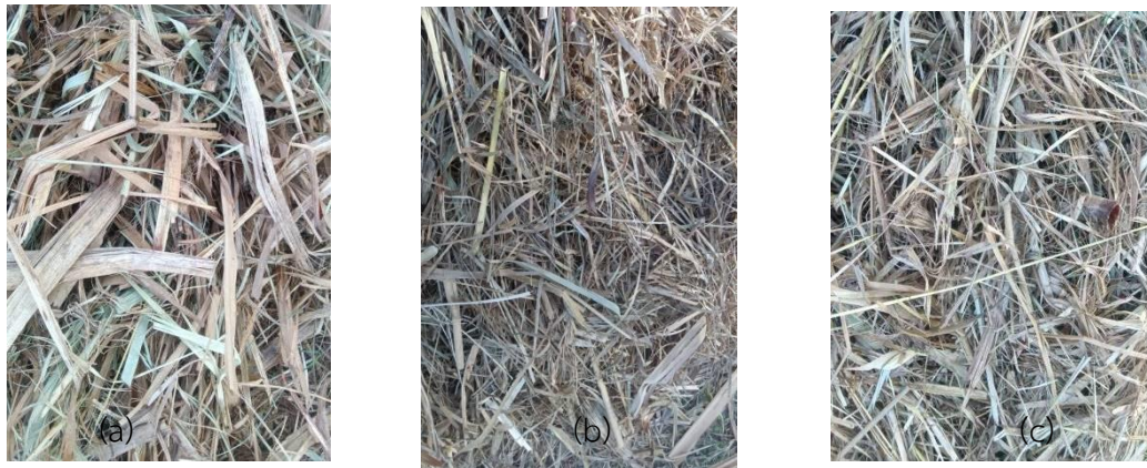
ภาพที่ 4 ลักษณะของ ใบอ้อย ยอดอ้อย และกาบใบ หลังการบด ด้วยเครื่องบด
