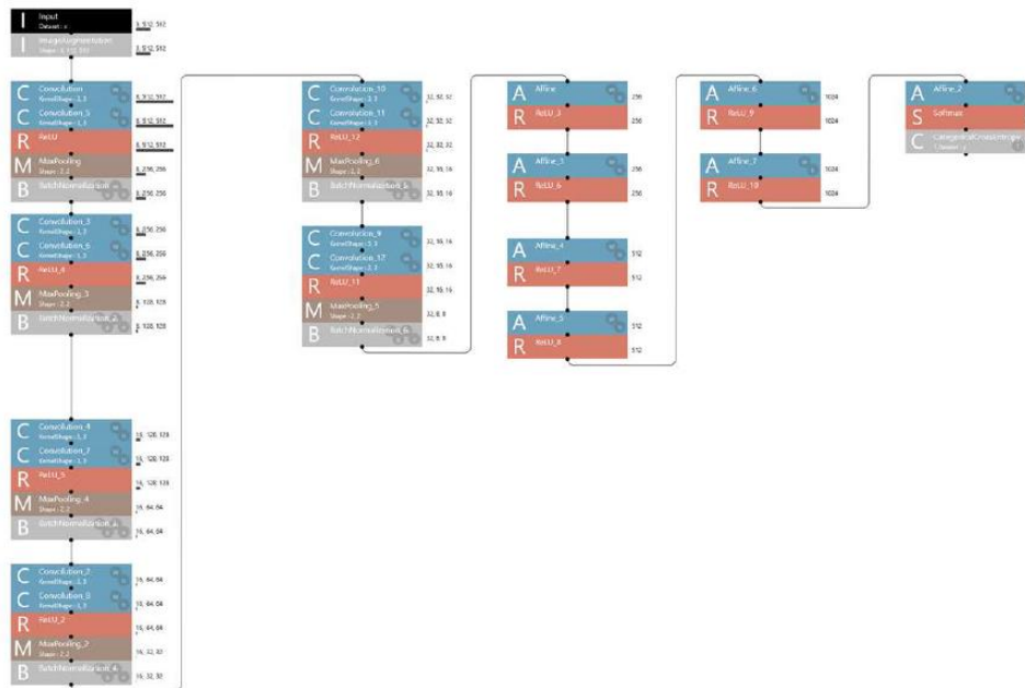
รูปที่ 4 สถาปัตยกรรมโครงข่ายประสาทเทียมของโมเดลการคัดแยกสีเปลือกผลสับปะรด
