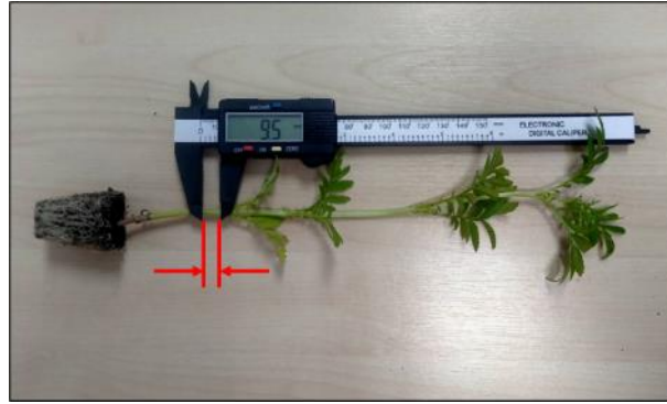
ภาพที่ 18 ตัวอย่างต้นกล้าที่เกิดการไหลของกริปเปอร์
