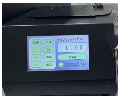
ภาพที่ 11 ด้านหน้าอุปกรณ์ตรวจปริมาณธาตุอาหารในดิน
