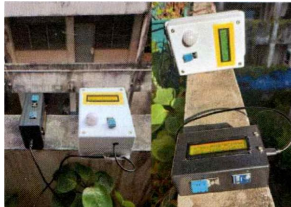
ภาพที่ 2 อุปกรณ์วัดและบันทึกข้อมูลความเข้มแสงอาทิตย์และอุณหภูมิที่ออกแบบสร้างขึ้นใช้งาน
