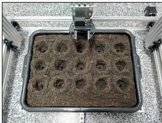
ภาพที่ 12 หลุมปลูกจำนวน 15 หลุมในถาดปลูกที่ขุดด้วยชุดดอกสว่าน
