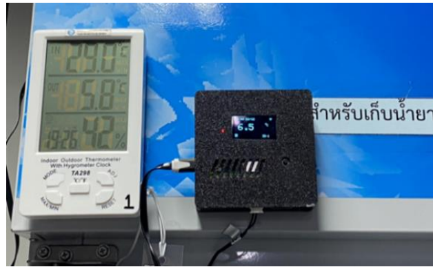
ภาพที่ 8 การเปรียบเทียบค่าอุณหภูมิที่วัดได้ของตู้แช่น้ำยาที่ 2
