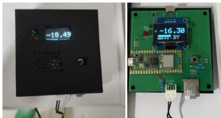
ภาพที่ 3 ต้นแบบกล่องบันทึกอุณหภูมิในระบบที่ได้พัฒนา
