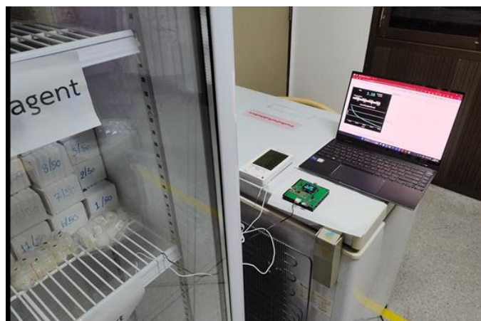
ภาพที่ 7 การวัดค่าอุณหภูมิตู้แช่น้ำยาที่ 2
